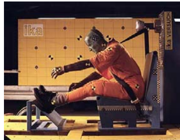
Dummy mit Markern für Crashtest
