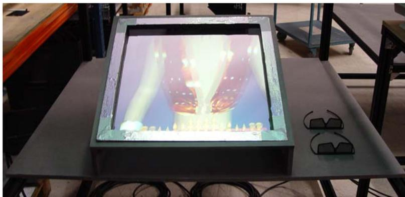
Bild 3.16: Das Stereobild auf der Rückprojektionsfläche wird über einen halbtransparenten Spiegel zum Betrachter reflektiert. Rechts neben dem Spiegel liegen die Polarisationsbrillen.
