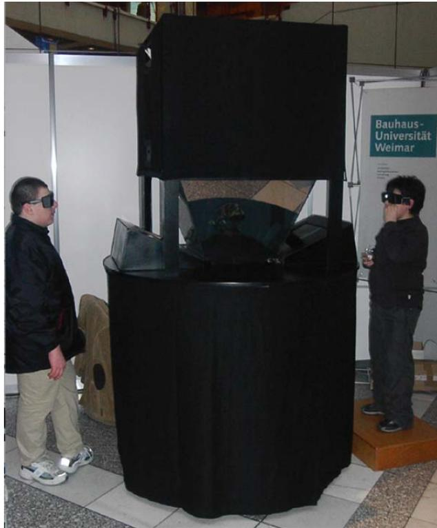
Bild 1.15: Monitor basierender Virtual Showcase Prototyp mit Saurierschädel aus [BES03].
