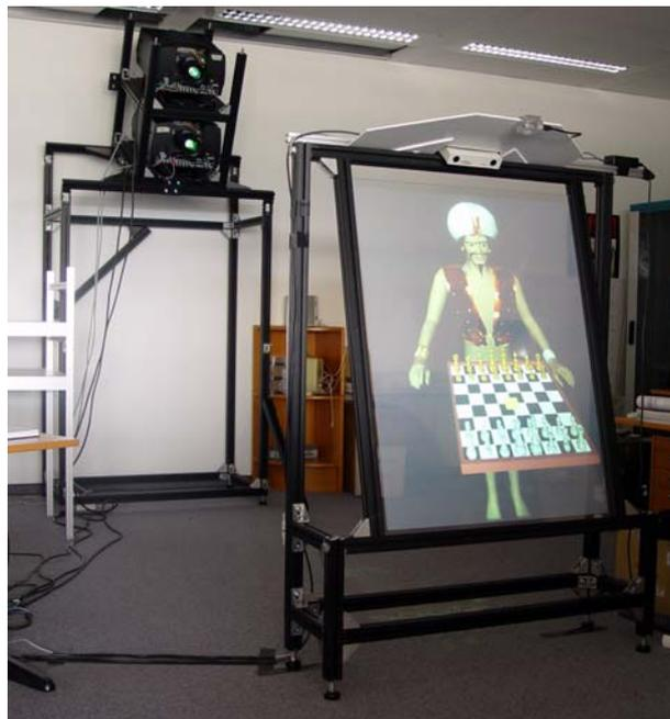
Bild 4.2: Hardwareaufbau des erweiterten Prototypen.
