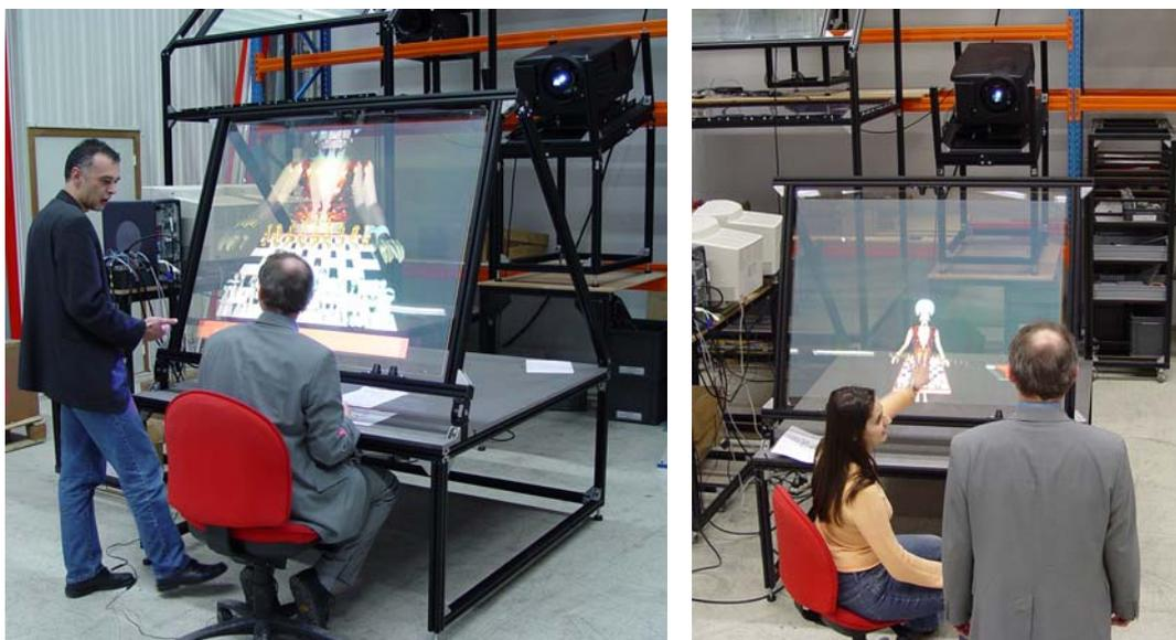
Bild 3.19: Aktive Stereo-Projektion auf eine holographische Rückprojektionsscheibe.
