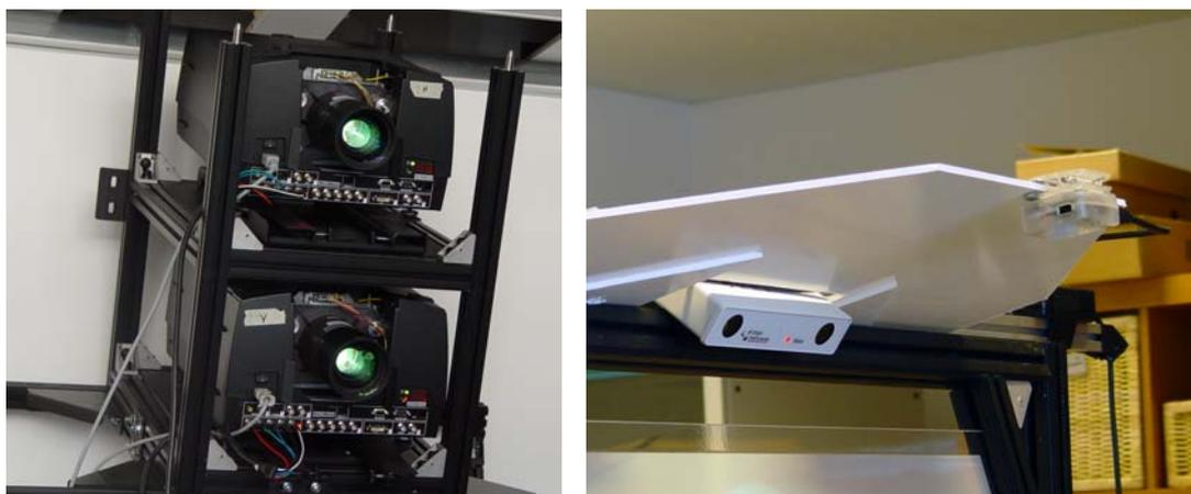
(a) BARCO Stereo-Videoprojektoren. (b) DynaSight-Tracker und FireWire-Videokamera.
