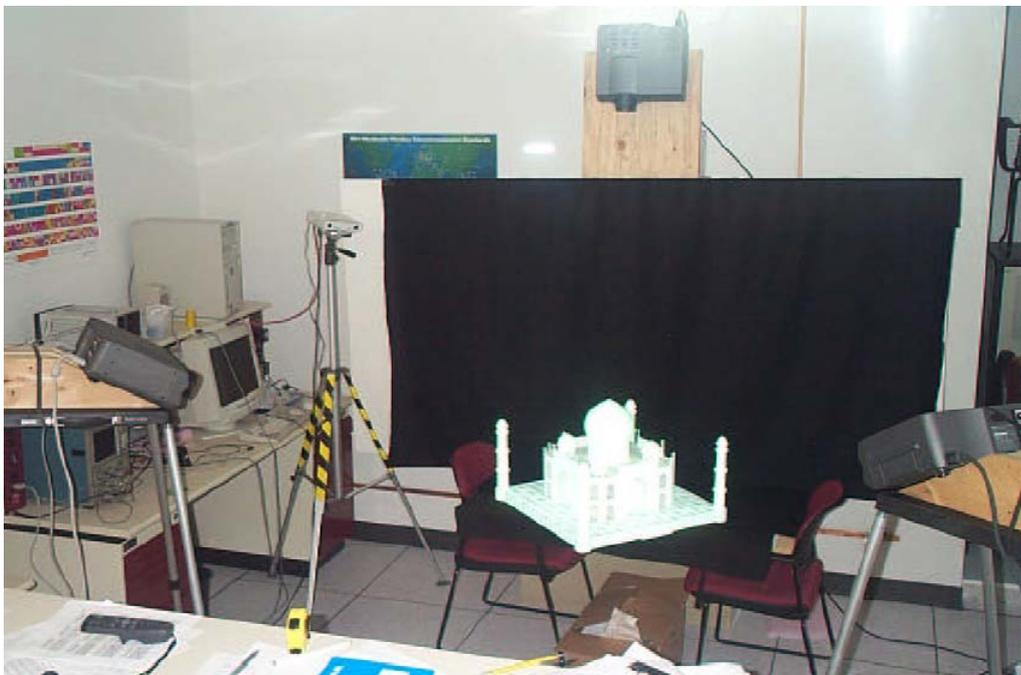
Bild 1.12: Ein Modell des Taj Mahal wird mit mehreren Videoprojektoren beleuchtet. Der optische Kopf-Tracker steht auf dem Stativ [RL01].
