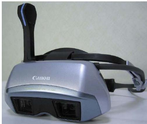
Bild 1.6: Canon VH-2002 Video-See-Through Head Mounted Display aus [Tam02].
