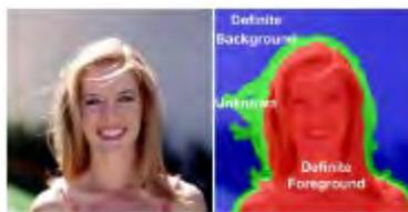
Abbildung 43: Ursprüngliches Bild (links) und Trimap (rechts). Abbildung aus [WC07]
