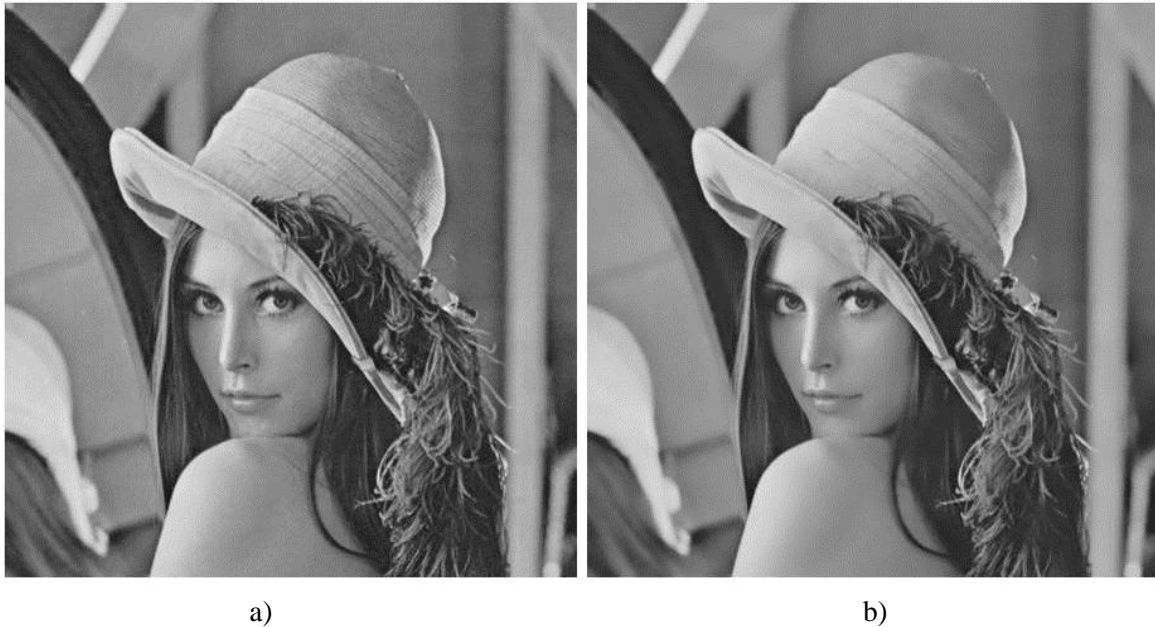
Abbildung 6.4: a) Eingabebild. b) Gefiltertes Ausgabebild unter Verwendung eines 8 \times 8 Guided Filters mit \epsilon = 0.004 . Als Eingabebild und Leitbild wurde eine 8-Bit Graustufenbild mit der Auflösung 1024 \times 1024 verwendet. Das Bild wurde in den homogenen Bildbereichen geglättet, Bildkanten blieben erhalten.
