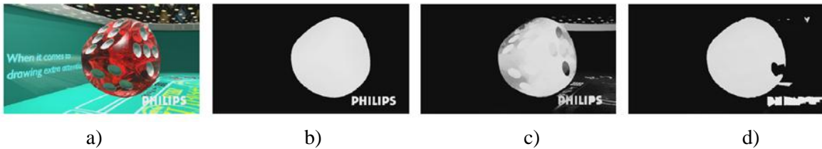
Abbildung 2.1: Beispielkonvertierung durch [14]: a) Frame des Eingabevideos. b) Ground Truth-Tiefenkarte. c) Mittels Bilateral Filter propagierte Tiefenwerte. d) Tiefenwerte nach der Korrektur von [14].
