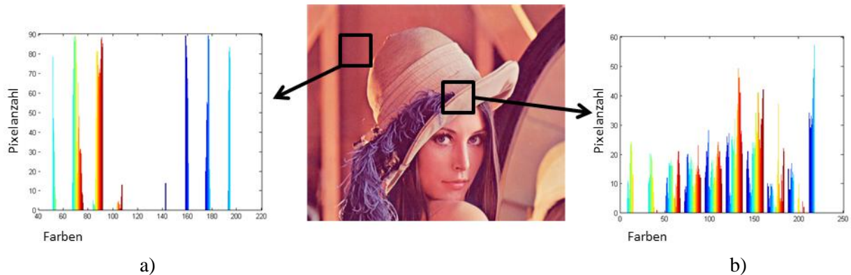
Abbildung 5.7: a) Homogene Bildregionen sind durch Histogramme mit wenigen hohen Werten gekennzeichnet. b) Texturierte Bildbereiche haben flache Histogramme mit weit gestreuten Werten.
