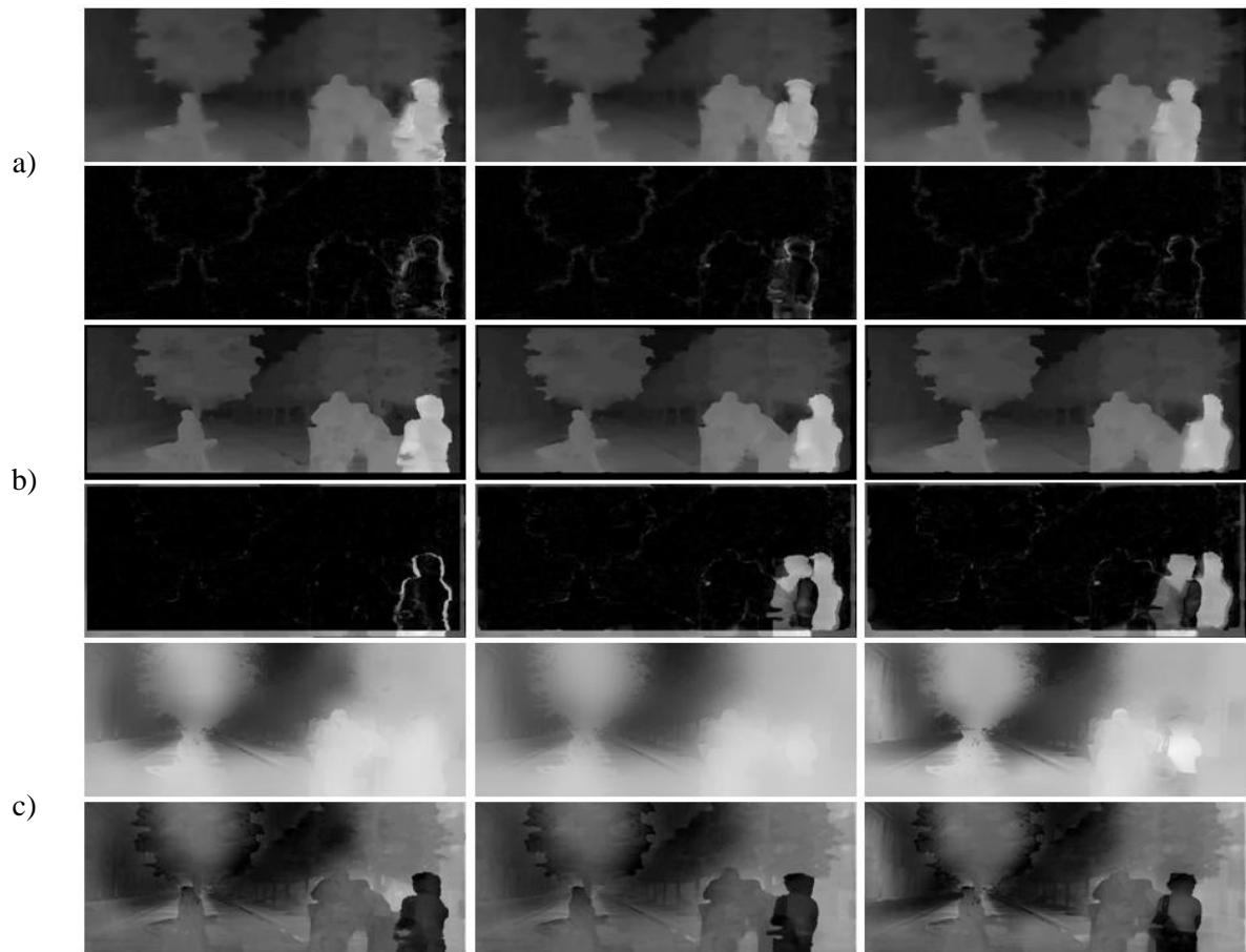
Abbildung 7.11: Ergebnisse des Testvideos „Stadt“. Von links nach rechts: Frame 1, Frame 9, Frame 18. Die erste Zeile enthält jeweils die resultierende Disparitätskarte, die zweite Zeile den Fehler zur Referenzlösung. a) Ergebnis der segmentierungsbasierten Propagierung ( MSE \times 100 = 0.08 ). b) Ergebnis des Algorithmus aus [14] ( MSE \times 100 = 1.92 ). c) Ergebnis des Algorithmus aus [1] ( MSE \times 100 = 12.15 ).
