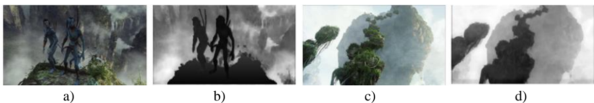
Abbildung 2.7: Beispielkonvertierung durch [19]: a) Frame eines Eingabevideos. b) Generierte Tiefenkarte mit Benutzerinteraktion. c) Frame eines Eingabevideos. d) Generierte Tiefenkarte ohne Benutzerinteraktion. [19]
