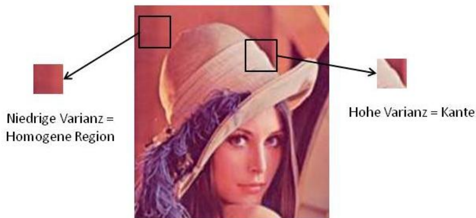
Abbildung 6.2: Homogene Regionen sind durch eine niedrige Varianz gekennzeichnet, das heißt, die Intensitätswerte innerhalb der Region sind ähnlich. Regionen, die eine Bildkante enthalten, zeichnen sich durch eine hohe Varianz aus. Nach [26]
