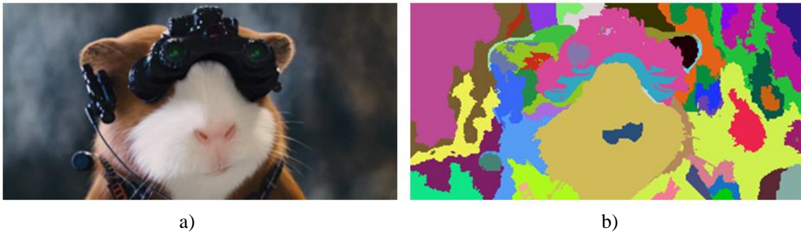
Abbildung 5.1: a) Eingabebild. b) Pixel mit ähnlichen Farbwerten werden im Zuge der Segmentierung in Regionen gruppiert. Zur Visualisierung wird jeder Region im Bild ein zufälliger Farbwert zugewiesen.
